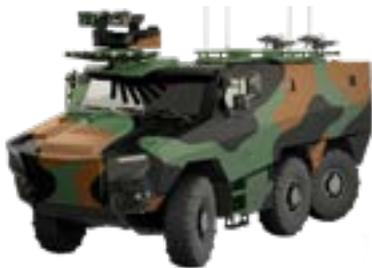
Le GRIFFON est un véhicule blindé de 24,5 tonnes qui succède au véhicule de l'avant blindé (VAB). Il a pour missions l'appui et le transport de combattants équipés du système d'armes FELIN au plus près des combats. Ce véhicule s'intégrera dans les groupements tactiques interarmes. Les premiers exemplaires ont été livrés début juillet 2019. Le premier marché de livraison pour l'armée de Terre s'élève à 936 GRIFFON d'ici 2025.
