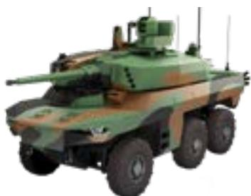
Le JAGUAR est un engin blindé de reconnaissance et de combat 6X6 de 25 tonnes qui doit progressivement succéder à partir de 2020 aux AMX-10RC, aux VAB HOT et aux ERC 90. Le JAGUAR conduit des missions de cavalerie légère. C'est un engin polyvalent qui peut par exemple s'intégrer dans un combat en zone urbaine ou en montagnes. Il est prévu d'en livrer 300 à l'armée de Terre dont 150 d'ici 2025.
