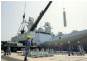
Rechargement des silos VLS d'une frégate Type 054A
